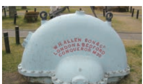
6 横滨船渠株式会社1号·2号船坞的排水泵的罩子
