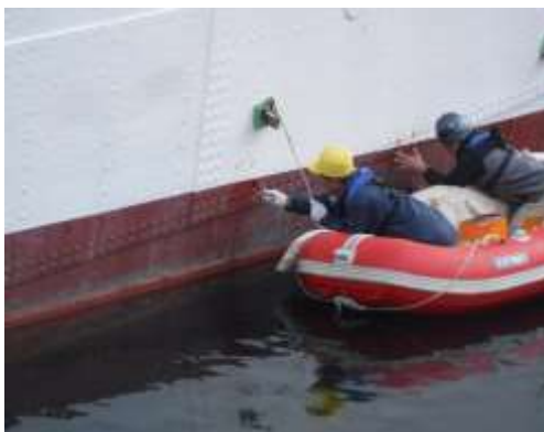
船体外板水線部塗装
